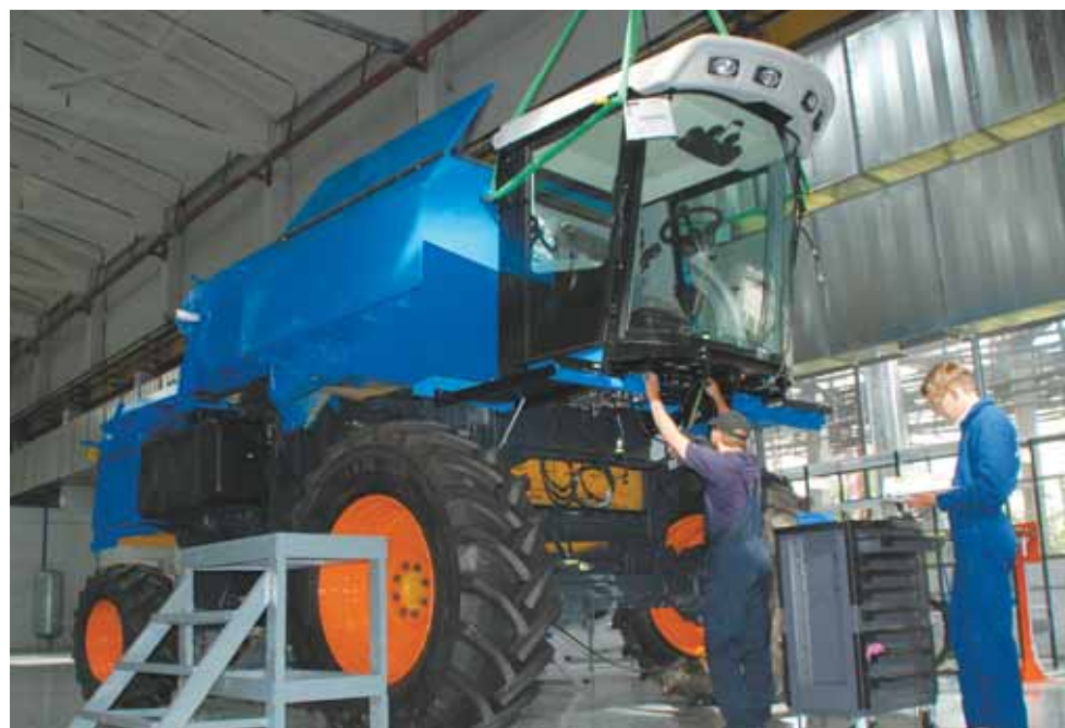
Первый комбайн АГРОМАШ-Енисей 5000 в процессе сборки на Владимирском моторо-тракторном заводе
