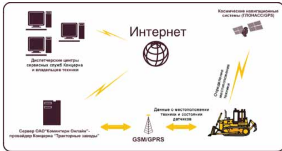
рис. 1. Архитектура системы мониторинга тракторной техники
